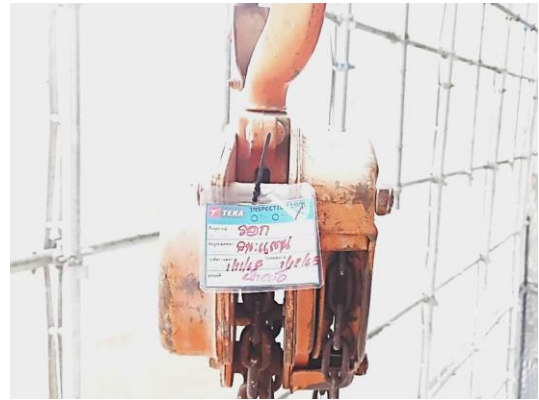
รูปที่ 3-18 ตรวจสอบสภาพเครื่องจักรให้พร้อมใช้งานอยู่เสมอ
